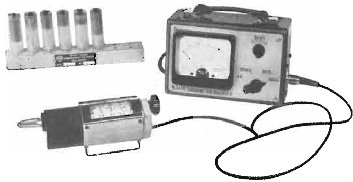
L'insieme costituente l'Ondometro Modello 235/B. Si osservi la testina rivelatrice, il voltmetro a valvola e la serie di bobine intercambiabili.
